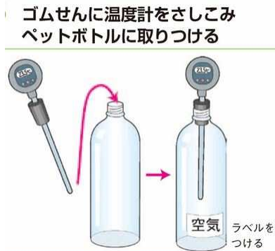
図 3-21 デジタル温度計の設置方法(リセマム)
