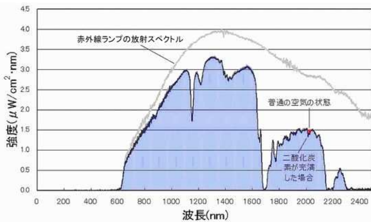
図 3-20 樹脂容器試料背後で計測した赤外線ランプの透過スペクトル
