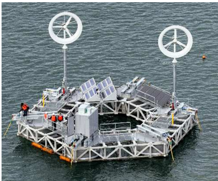
写真 6-3 博多湾に設置された実証実験用風レンズ風車
